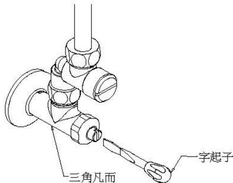
水質不佳時易造成過濾網阻塞使水量變小，此時先以一字起子將三角凡而關閉，再以一字起子將過濾網組取出清洗再裝回即可。
