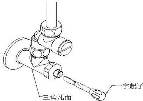
水質不佳時易造成過濾網阻塞使水量變小，此時先以一字起子將三角凡而關閉，再以一字起子將過濾網組取出清洗再裝回即可。
